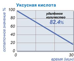
Испытательный метод: JEM 1417, помещение: 30м3, герметичное помещение. Условие измерений: сигаретный дым (5 одновременно горящих сигарет)
