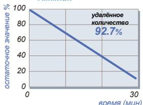
Испытательный метод: JEM 1467 помещение: 1м3, ящик с акриловым герметиком. Условие измерений: сигаретный дым (5 одновременно горящих сигарет)
